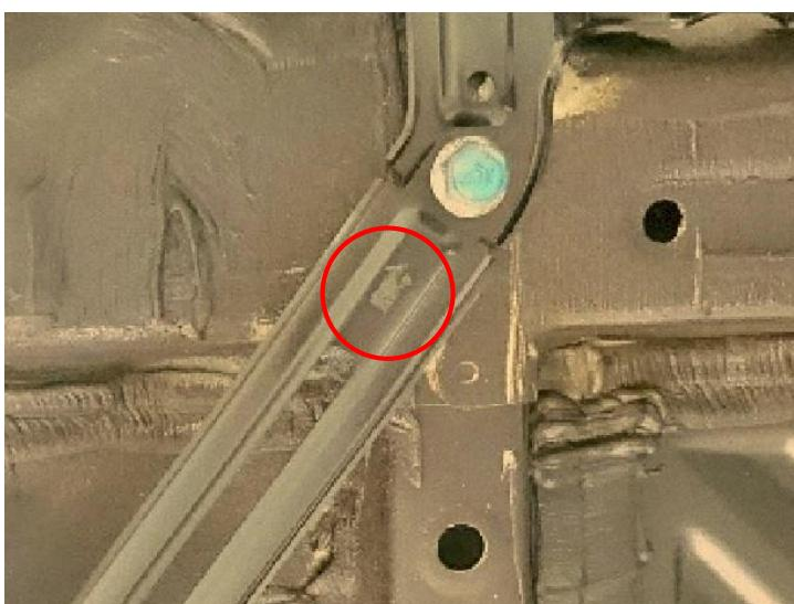
POINT) ロアアームコンプライアンスボルトを締めるときは下画像のようにロアアームをジャッキで支えるとボルト穴が合い、締め易いです。
