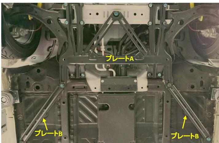
⑤プレートBの矢印を車両進行方向に合わせて、プレートAと共に締めします。
