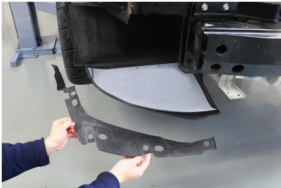
⑪ インナーフェンダー後端部に仮組したバンパーを合わせ、穴位置をマーキングし、3mmの下穴を開けます。
