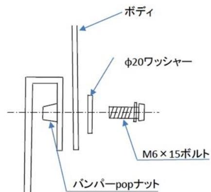
⑦ バンパー後部の固定は純正ヘックスボルトを再使用します。
