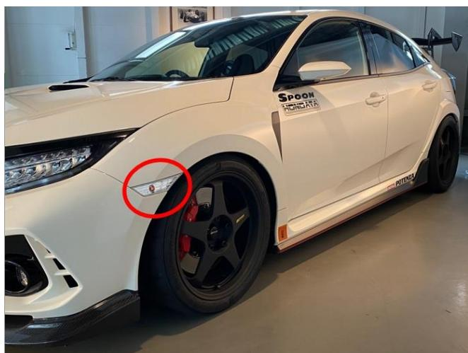
① フロントインナーフェンダーを捲り、サイドマーカーの純正カプラを外し、付属のハーネスを接続します。
