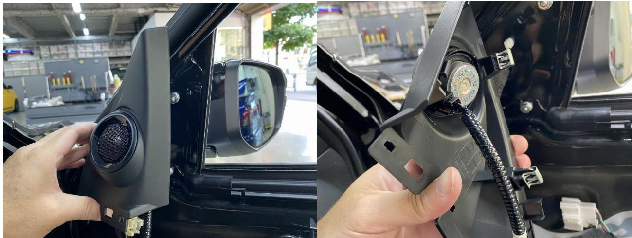
④ ミラーハーネスカプラーを外します。ミラーを支えながらナット×3個を外し、ミラーASSYを取り外します。
