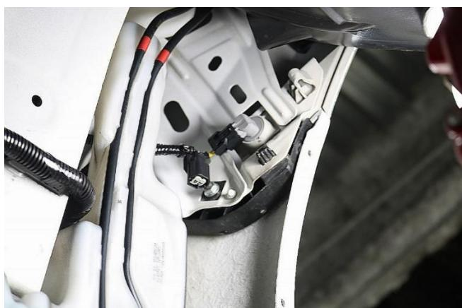
① エンジルーム内ヘッドライトの 8Pカプラを外し、付属ハーネスの赤、黒の配線をエレクトロタップで接続します。
