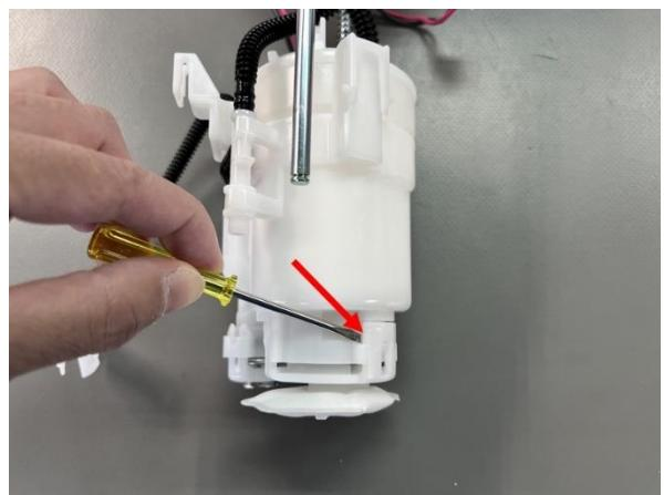
9. フューエルポンプが外れたら、赤矢印のフューエルフィルターを外し、**付属の①大容量ポンプに移植します。**
