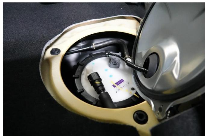
3. フューエルロックナットを専用ツール（07AAA-S0XA100）を使用して開け、フューエルポンプモジュール ASSYを取り出します。
