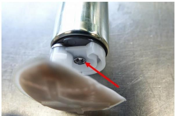
付属ポンプにフィルターを移植したら、黄矢印のスペーサーも移植し、**赤矢印のOリングは付属の②フューエルポンプ用Oリングを使用してください。**
