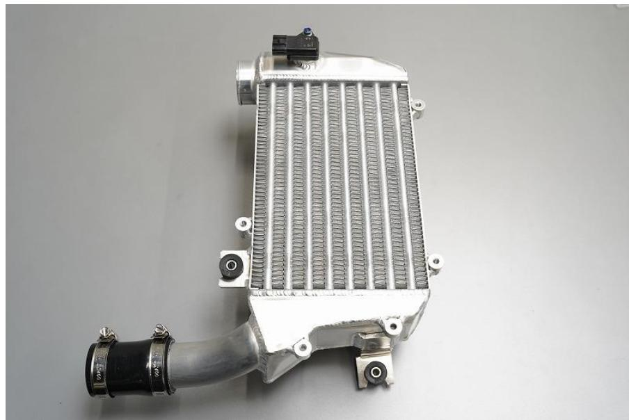
5. 画像のように矢印部のブラケットに付属の L 字ステーをフランジボルト M6 × 15 で仮組します。
