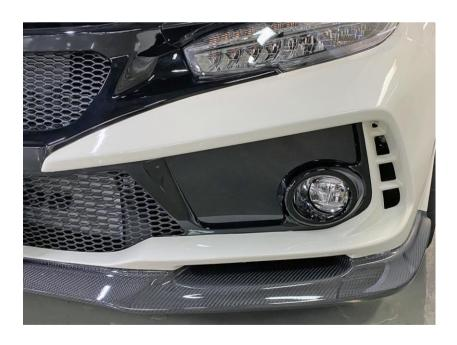
注)ミリ波レーダー部破損や悪路、雨天走行時など、純正バンパー同様にホンダセンシングに エラーが生じる可能性がございます。
