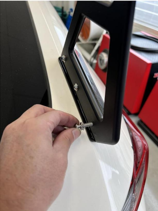
③ 付属のM5×25mm ボルト、ナットを使用してウイングを取り付けます。
