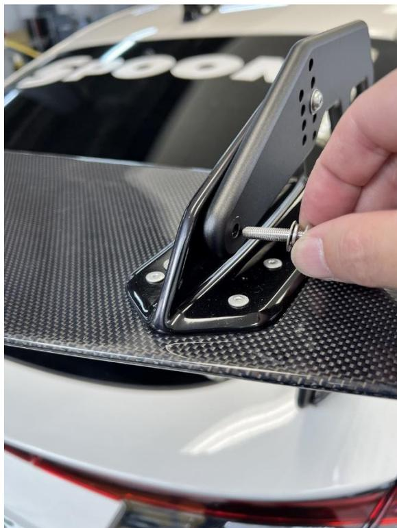
④ 付属のM5×12mm ボルトを使用して翼端板を取り付けます。
