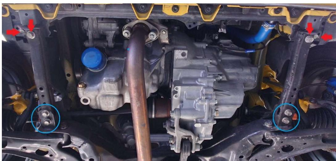
② ボルトを外したロッド前方と車体フレームの間にブラケットを差し込みボルトを仮止めします。
