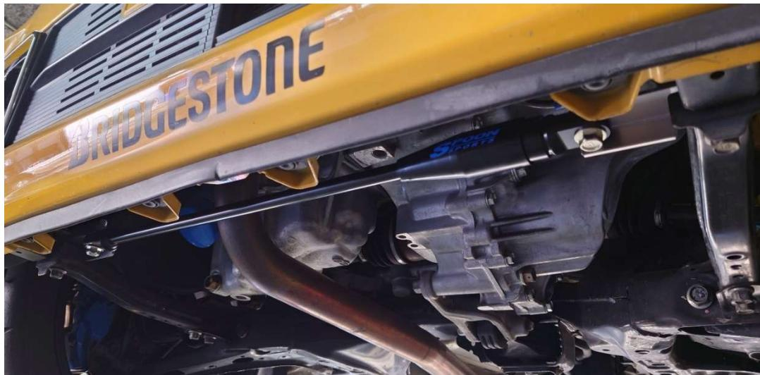
④ 全てのボルトを締め付けて完了です。(トルクは HONDA サービスマニュアル参照)
